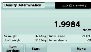
Dopo aver determinato i pesi necessari, la densità del campione viene visualizzata in **g/cm<sup>3</sup>** (insieme al peso in aria e in acqua) sulla schermata dell'applicazione.
