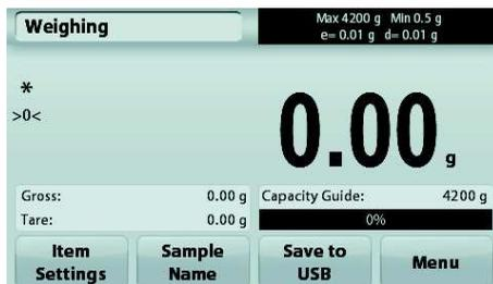
Pesatura schermata principale dell'applicazione con LFT (Omologazione per Transazioni Commerciali) ON.
