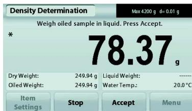
Dopo aver determinato i pesi necessari, la densità del campione viene visualizzata in  $\text{g/cm}^3$  (insieme al peso in aria, oleato, non oleato e in acqua) sulla schermata dell'applicazione.
