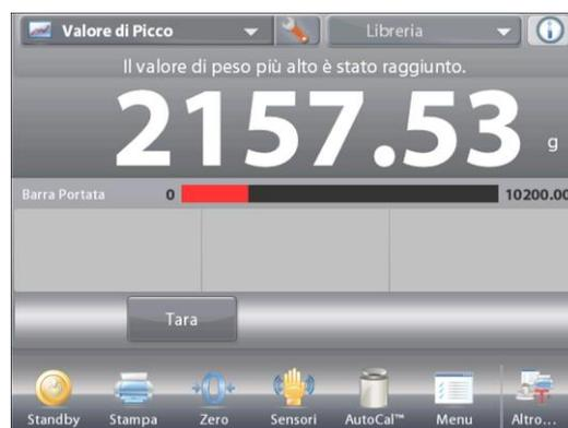
La lettura del valore più elevato del peso stabile viene memorizzato fino a quando il peso non viene rimosso.
