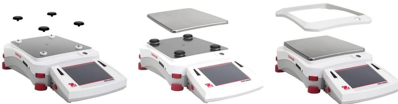
Nota: è possibile utilizzare la bilancia senza scudo per correnti d'aria. Tuttavia, a seconda delle condizioni dell'ambiente, i risultati visualizzati possono essere lievemente meno stabili.
