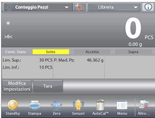
Premere il pulsante Configurazione (a forma di chiave) per accedere al menu di configurazione conteggio.
