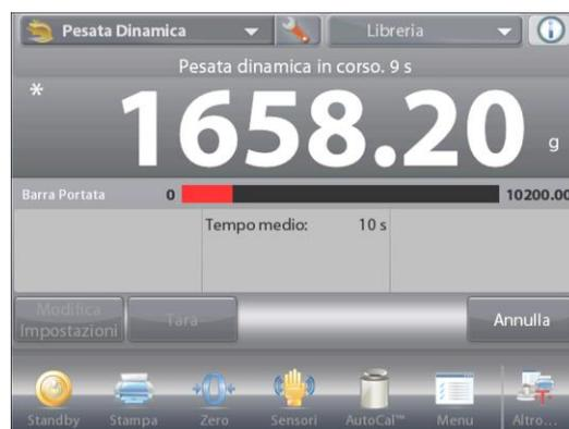
Al termine del conteggio alla rovescia, il risultato viene visualizzato e memorizzato.
