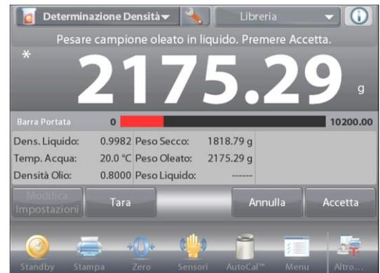
Dopo aver determinato i pesi necessari, la densità del campione viene visualizzata in **g/cm<sup>3</sup>** (insieme al peso in aria, oleato, non oleato e in acqua) sulla schermata dell'applicazione.
