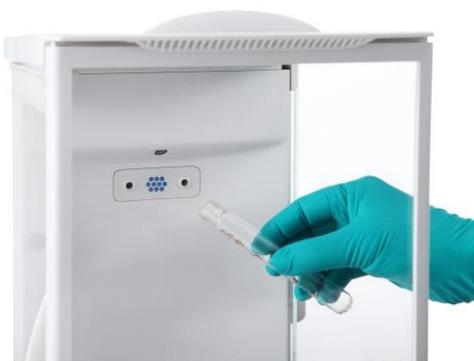
Lo ionizzatore genera ioni bipolari in maniera continua, mediante la scarica a corona in CC separatamente da elettrodi di scarica positivi e negativi e indirizza l'aria ionizzata su un corpo carico per eliminare l'elettricità statica. Gli ioni generati sono ben bilanciati in termini di polarità e in grado di eliminare l'elettricità statica indipendentemente dalla polarità del corpo caricato.
