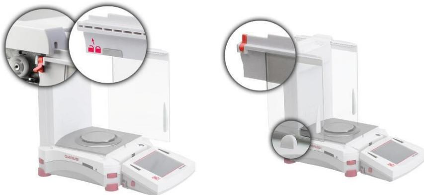
Posizionare lo sportello in vetro scorrevole. Aprire la linguetta di blocco (superiore), inserirla nella scanalatura e farla scorrere all'interno della scanalatura inferiore. Chiudere la linguetta di blocco.
