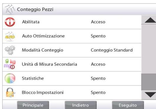
**I valori di configurazione dell'applicazione di conteggio sono illustrati di seguito**
