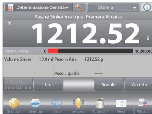
Dopo aver determinato i pesi necessari, la densità del campione viene visualizzata in **g/cm<sup>3</sup>** (insieme al peso in aria e nel liquido) sulla schermata dell'applicazione.
