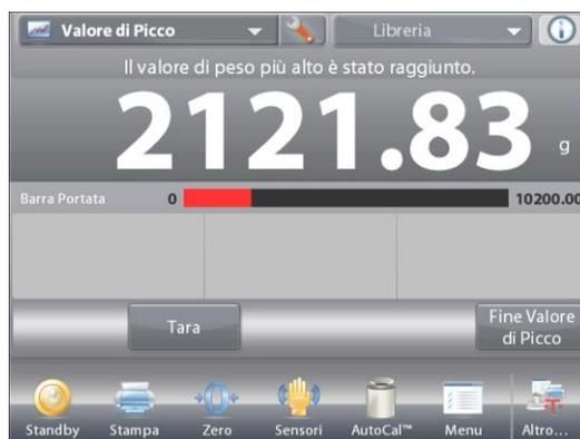
La lettura del valore più elevato del peso stabile viene memorizzato per un tempo indeterminato.
