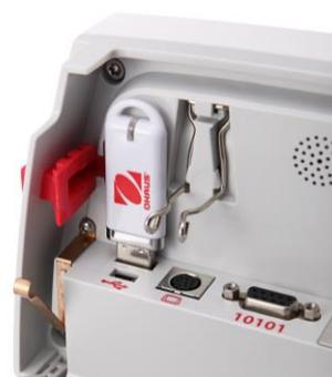
Connessioni di interfaccia sul retro del terminale.
