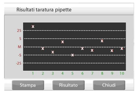
**Nota:** per visualizzare le schermate dei risultati o del grafico dalla schermata iniziale, premere il pulsante **Visualizza risultati**. Per avviare un nuovo processo di taratura pipette, premere **Avvia Taratura pipette**.
