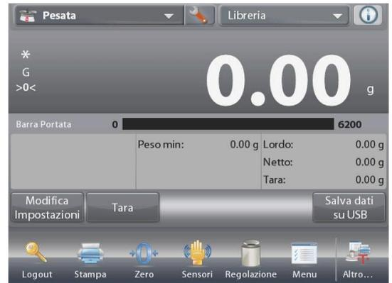
Viene visualizzato il **menu di configurazione dell'applicazione**.
