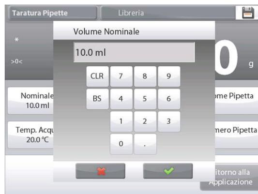
Per regolare la temperatura dell'acqua, toccare il pulsante **Temperatura acqua**.
