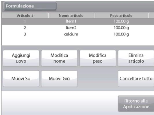
Per modificare il peso del componente predefinito, premere **Modifica peso**. Viene visualizzata la schermata per l'immissione numerica. Digitare il nuovo peso e premere ✓.
