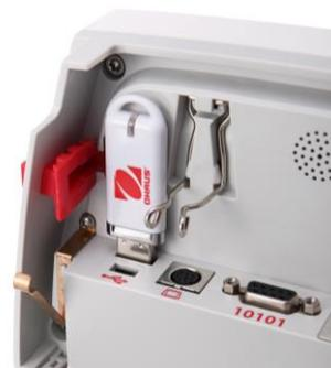
Connessioni di interfaccia sul retro del terminale.
