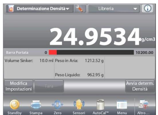
4.10.6 Misurazione della densità di materiale poroso tramite olio
