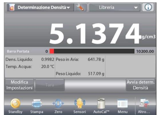
Dopo aver determinato i pesi necessari, la densità del campione viene visualizzata in g/cm<sup>3</sup> (insieme al peso in aria e in acqua) sulla schermata dell'applicazione.
