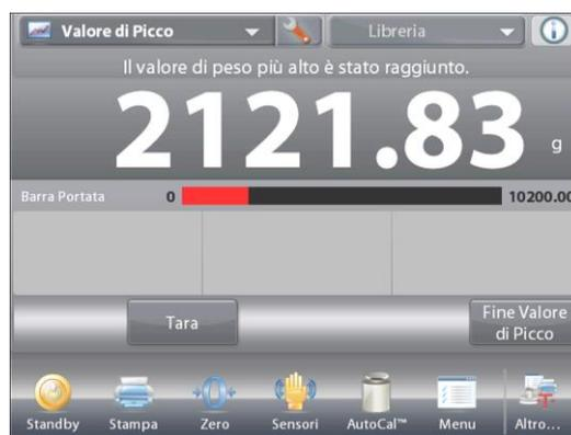
La lettura del valore più elevato del peso stabile viene memorizzato per un tempo indeterminato.
