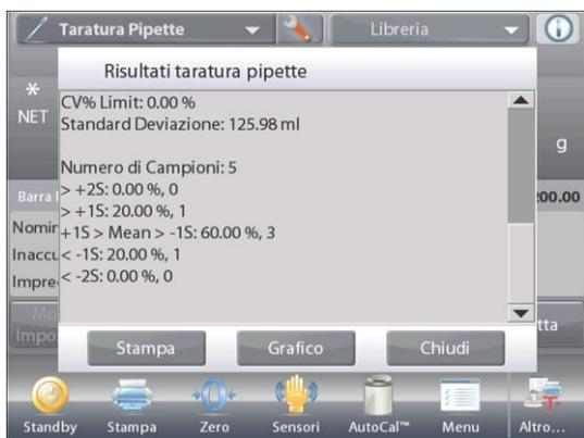
Quando sono stati erogati i pesi di tutti i campioni, viene automaticamente visualizzata la schermata **Risultati**.
