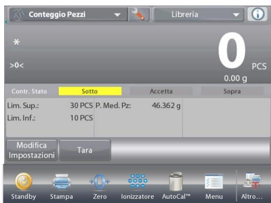
Premere il pulsante Configurazione (a forma di chiave) per accedere al menu di configurazione conteggio.
