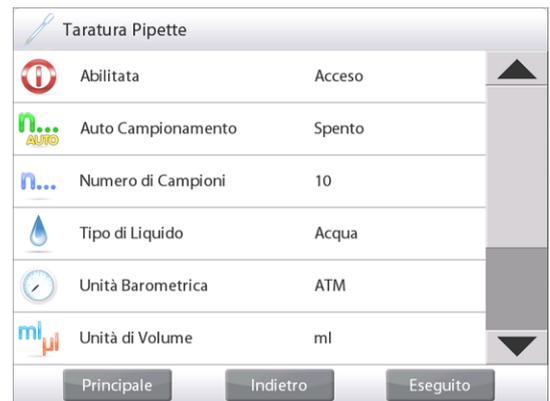
**Configurazione dell'applicazione Taratura pipette** (i valori predefiniti sono riportati in **grassetto**)
