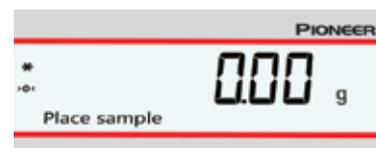
Ampio angolo di visualizzazione con display LCD retroilluminato. Il display a 2 righe fornisce ulteriori informazioni o suggerimenti di guida per l'utilizzatore. La barra di capacità visualizza l'avanzamento della pesata.
