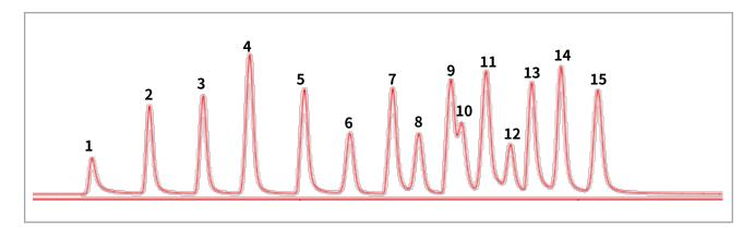
**Fig 4. chromatogram of oxygenates using D4815 qualitative ID mix standard (47213)** 1. Methnaol, 2. Ethanol, 3. iso-Propanol, 4. tert-Butanol, 5. n-Propanol, 6. MTBE, 7. sec-Butanol, 8. DIPE, 9. iso-Butanol, 10. ETBE, 11. tert-Amylalcohol, 12. DME, 13. n-Butanol, 14. Benzene, 15. TAME
